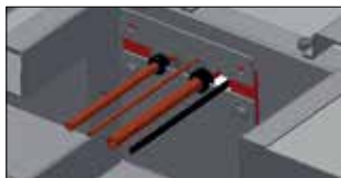
Abb. 11. Ableitung und Abdichtung der Leitung der Kapillare, der Magnetzündleitung, der Röhre des Hauptbrenners und der Röhre des Kontrollbrenners
