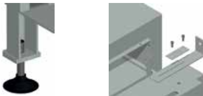
Rys. 3. Stopka poziomująca oraz regulowany uchwyt mocujący
