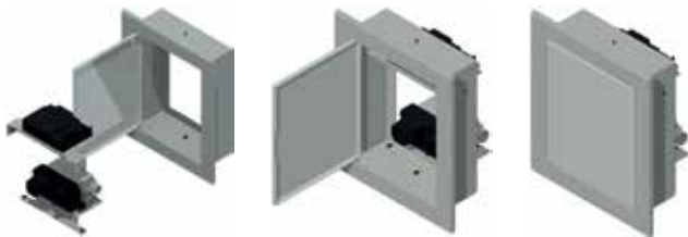
Abb. 8. Montage des Gassteuergerätes zusammen mit dem Empfangsgerät im Verteilerkasten
