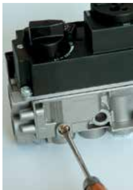
Рис.15. Способ регулировки минимальной высоты пламени главной горелки
